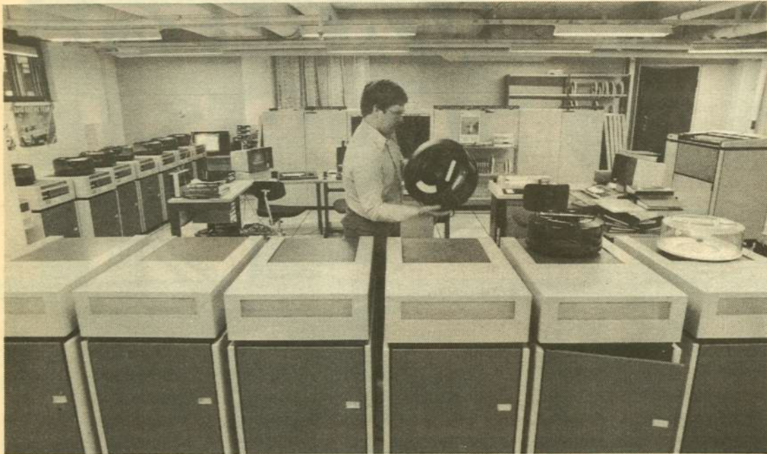
Tämä Perkin-Elmer-laitteisto ylläpitää mm. telset-järjestelmää. Edessä ja vasemmalla 15 levyasemaa, takana keskusyksiköt ja nauha-asetat, oikealla kirjoitin.
